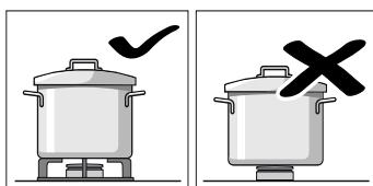
Așezați recipientele pe grătare, niciodată direct pe arzător. Asigurați-vă că grătarele și capacele arzătoarelor sunt bine poziționate înainte de a le folosi.
