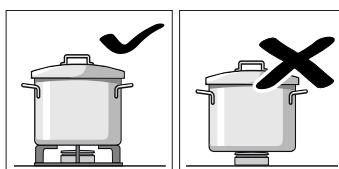
Stawiać naczynia na rusztach, w żadnym wypadku nie stawiać ich bezpośrednio na palniku. Przed użyciem palników sprawdzić, czy ruszty i nakładki palników są prawidłowo założone.
